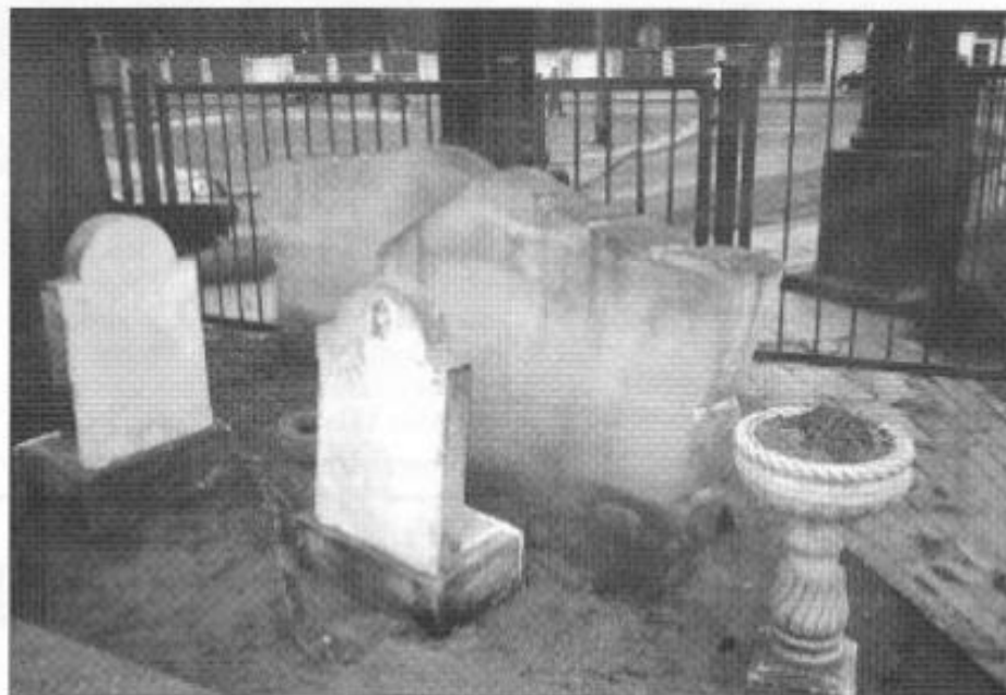
Zakład Sypniewskich przy ul. Powązkowskiej w Warszawie: oczyszczone już nagrobki i spatynowane płyty z piaskowca, które poddane zostaną dalszej obróbce. Patyna szpeci kamień, ale też stanowi warstwę izolacyjną. Fot. M. Pawlak.
